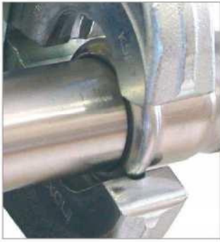
Fig. 54 - Introducir la ranura de la mordaza en el resalte del accesorio.
