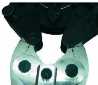
Fig. 59b - Mordaza bien introducida PRENSAR.
