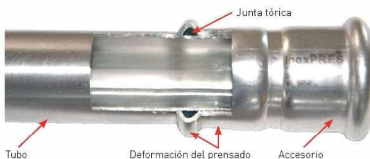
Fig. 2a - Unión prensada.
