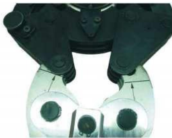
Fig. 59a - Mordaza mal introducida NO PRENSAR.
